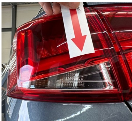
Fissure/rayure profonde dans les optiques de phares ou de feux arrières
