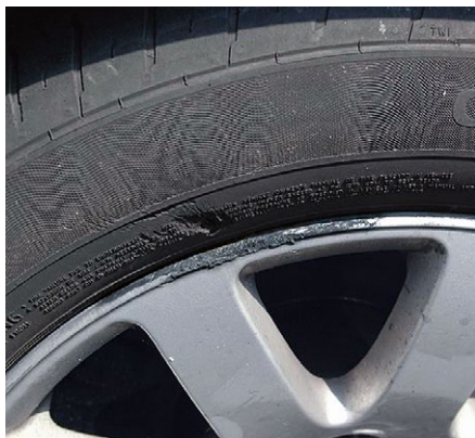
Flancs des pneus endommagés
