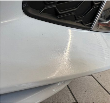
Réparation de peinture insuffisante (Spotrepair)
