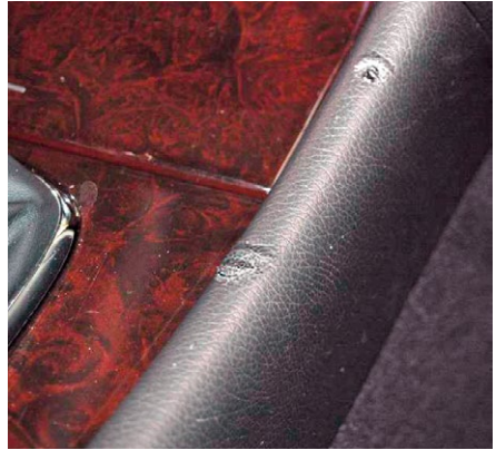
Déformation des garnitures en plastique
