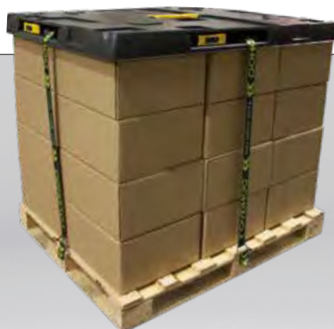
Het deksel is voorzien van volledig geïntegreerde spanbanden met ratelmechanisme. Het Clever lid is verkrijgbaar met 2 of 4 spanbanden. De banden zijn als cassette uitwisselbaar of vervangbaar.
