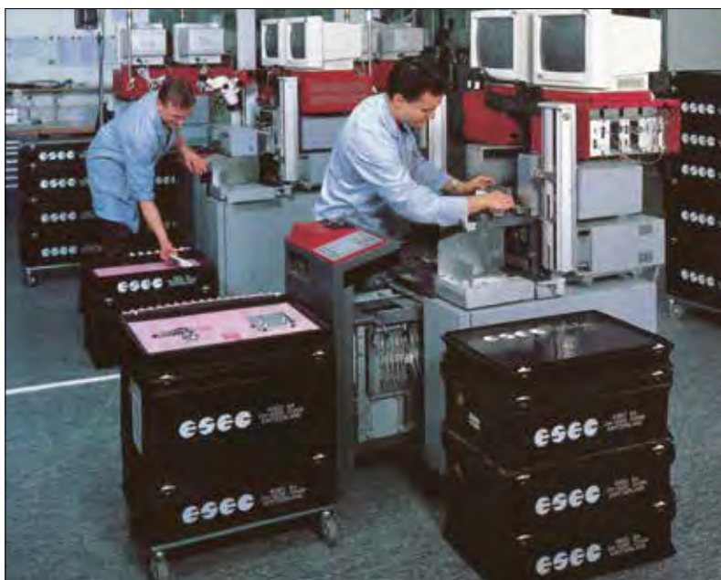
In een ESD veilige werkomgeving zijn niet alleen de bakken, maar ook de vloer, schoenen, werkplekken en wagens geleidend!
