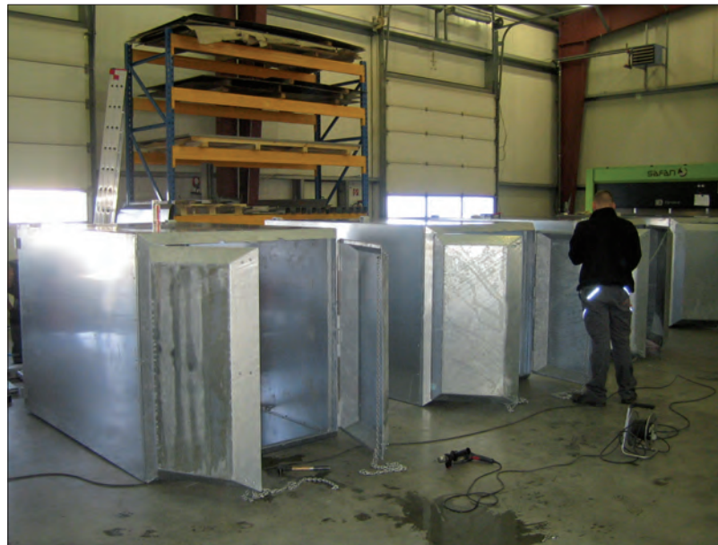
Afmonteren van de bodemkleppen.
