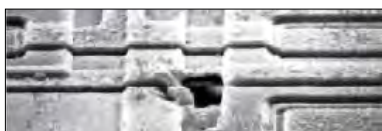
Schade aan een microprocessor door statische ontlading.
