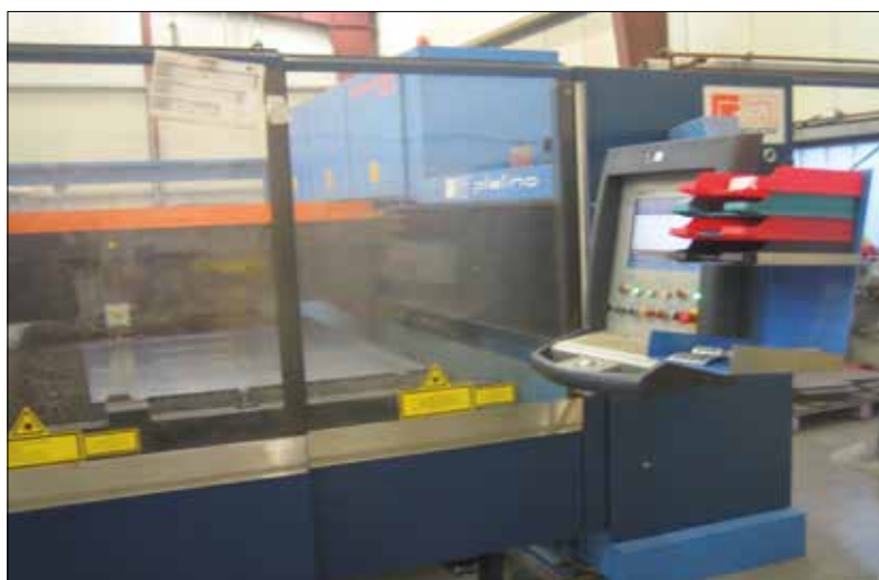
Onze 4.000-W lasersnijder maakt zelfs productie in kleine hoeveelheden winstgevend.
