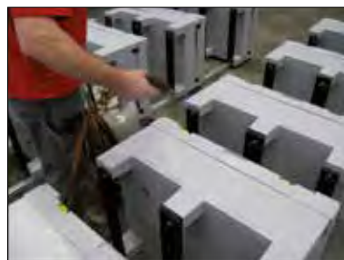
De bakken worden gevuld zodat de inkt goed aan de bak blijft hechten.
