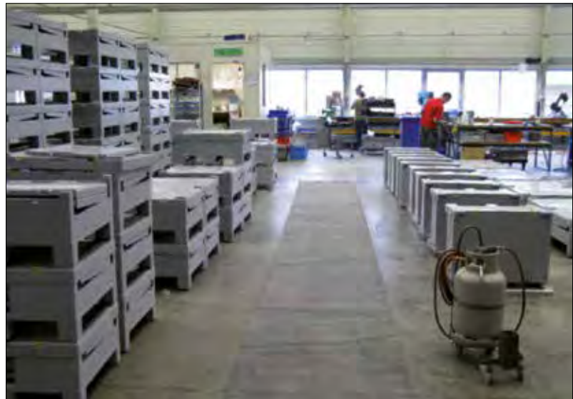
Aangezien de bakken aan beide zijden bedrukt dienen te worden, is er een rail gemaakt om de bakken op te laten drogen.
