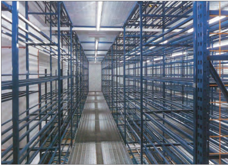
2 verdiepingen Protub stellingen met gangpaden.
