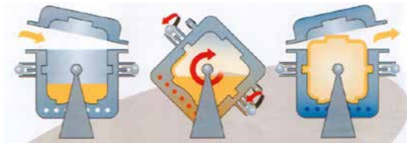
Schematische weergave van het rotatieproces.
