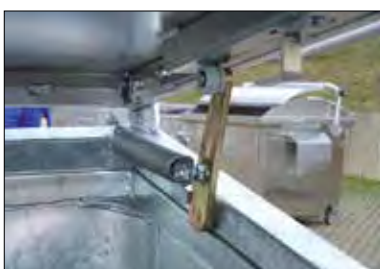
Deksel blijft open staan door veermechanisme.
