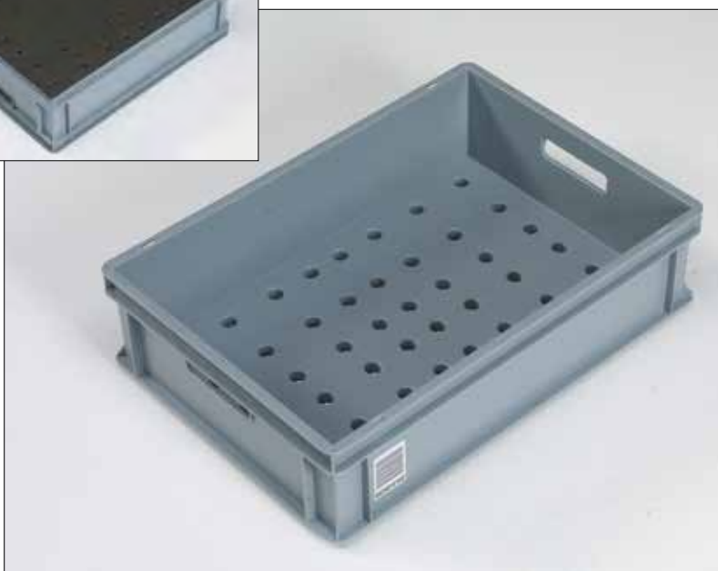
Bak voor farmaceutische grondstoffen voor in een hoogbouwmagazijn. Speciaal: Euronorm binnenmaat 605 x 405, dubbelwandige zwaarlastbodem met uitstroomopeningen t.b.v. sprinklerinstallatie en reinigen.
