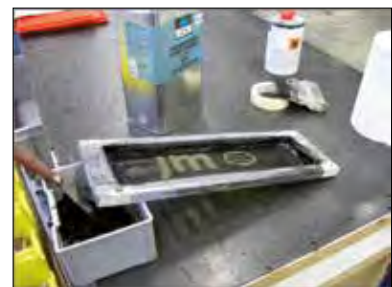
De zeef wordt grondig schoongemaakt, zodat de inkt gelijkmatig uitgesmeerd kan worden.
