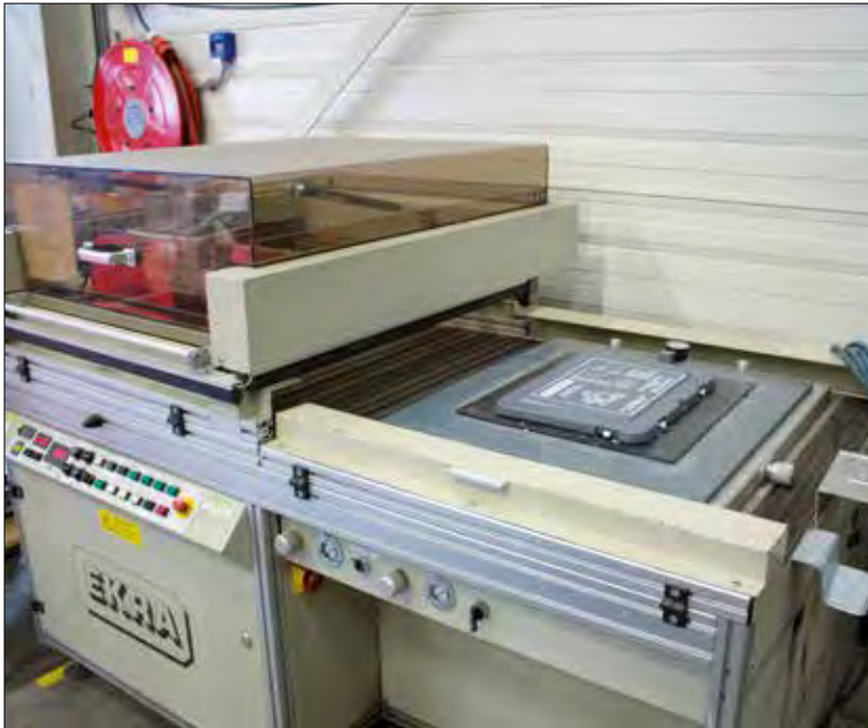
Machinaal zeefdrukken van deksels. Het deksel wordt machinaal onder de zeef gebracht en de inkt wordt automatisch gedrukt.
