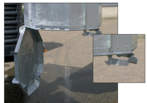
Het ledigen van stalen binnenbak met enkele klep gaat d.m.v. een 1-haak systeem met speciale haak.
