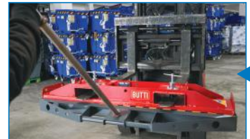
Sistema di apertura facilitato tramite leva in acciaio inox Easy opening system with stainless steel lever
