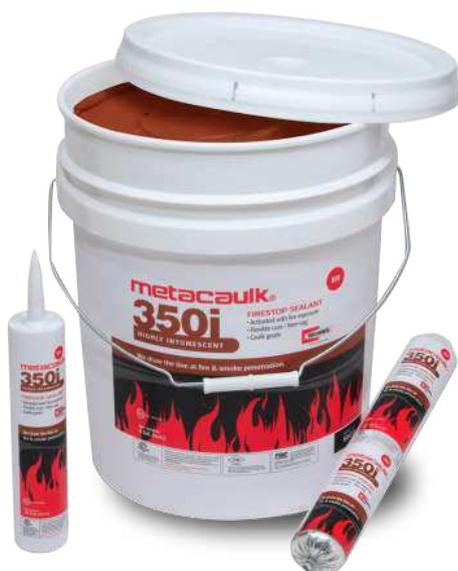
Sellador cortafuego de un solo componente, esta hecho a base de agua, es extremadamente intumescente, no se escurre y es fácil de utilizar. En el caso de incendio, Metacaulk® 350i previene la propagación de fuego, humo, gases calientes y agua a través de juntas abiertas y penetraciones de pared suelo/techo.
