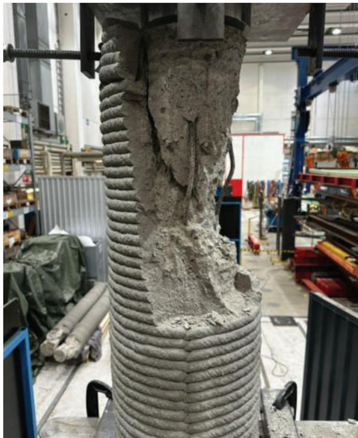
Fig. 3: Columna nº III después del fallo
