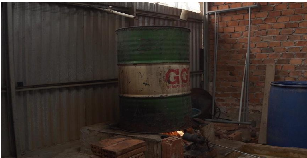
Gambar 14. Pemakaian Drum Oli Bekas untuk Perebusan Kedelai Sumber: Dokumentasi Prospect Institute, 2023
