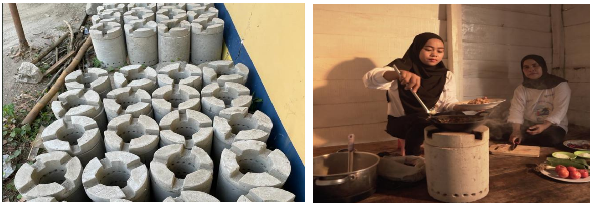
Gambar 26. Kompor Berbahan Bakar Pellet Eceng Gondok
