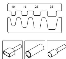
**HERRAMIENTA DE CRIMPADO PARA PUNTERAS DE 10 A 35 MM<sup>2</sup> (AWG 8-2)**
