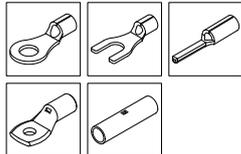
**HERRAMIENTA DE CRIMPADO CON REDUCCIÓN PARA TERMINALES DE COBRE NO AISLADOS DE 0,5 A 10 MM<sup>2</sup> (AWG 20-8)**
