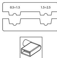
**HERRAMIENTA DE CRIMPADO PARA TERMINALES HEMBRA AISLADOS DE CONEXIÓN RÁPIDA DE 0,5 A 2,5 MM<sup>2</sup> (AWG 20-14)**
