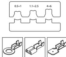
**HERRAMIENTA DE CRIMPADO PARA TERMINALES ABIERTOS DE BARRIL DE 0,5 A 6 MM<sup>2</sup> (AWG 20-10)**
