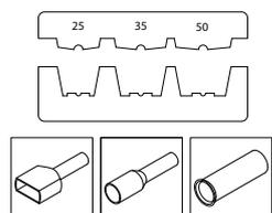
**HERRAMIENTA DE CRIMPADO CON REDUCCIÓN PARA PUNTERAS DE 25 A 50 MM<sup>2</sup> (AWG 4-1)**
