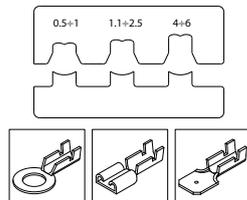
**HERRAMIENTA DE CRIMPADO CON REDUCCIÓN PARA TERMINALES DE LATÓN ABIERTOS DE BARRIL DE 0,5 A 6 MM<sup>2</sup> (AWG 20-10)**
