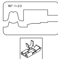
**HERRAMIENTA DE CRIMPADO CON REDUCCIÓN PARA TERMINALES DE BANDERA HEMBRA DE CONEXIÓN RÁPIDA - 2,5 MM<sup>2</sup> (AWG 14)**
