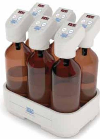
Systèmes de mesure pour la détermination fiable de 90 à 999 ppm de DBO. Complets avec têtes de capteurs et agitateur magnétique multipostes.
