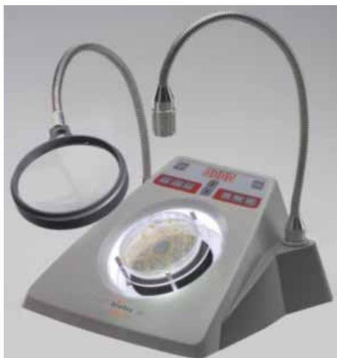
Pour un comptage fiable et rationnel des colonies de bactéries et de plaques de phages dans ou sur agar nutritif et disques nutritifs. Conçu pour un travail ergonomique et détendu.
