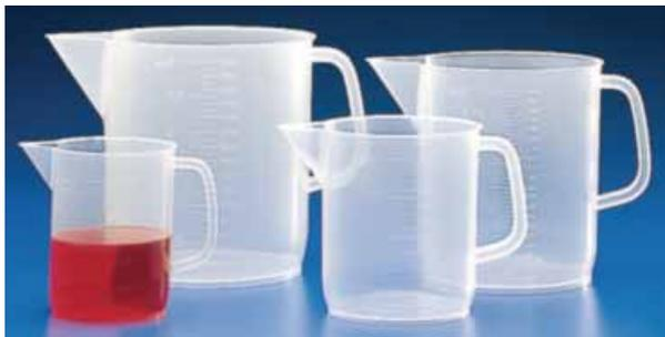
Forme basse. Autoclavable. Très bonne transparence en cas de remplissage avec des liquides. Graduations en relief. Bec verseur fonctionnel, donc pas de gouttes. Avec poignée pour le pouce sur l'anse.
