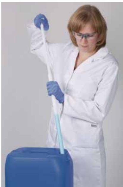
Prélèvement d'échantillons sans contamination. Fabriqué en salle blanche, emballé individuellement et tout de suite prêt à l'emploi. Pour liquides très visqueux jusqu'à max. 100 000 mPas.
