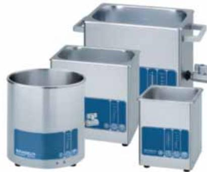
Bains à ultrasons dans un bâti en acier inox avec chauffage, plage de température réglable de 20 à 80 °C et LED d'alarme en cas de surtempérature, dégazage de liquides (DEGAS), fonction Impulsion, SweepTec®. Alimentation 230 V~, 50/60 Hz.
