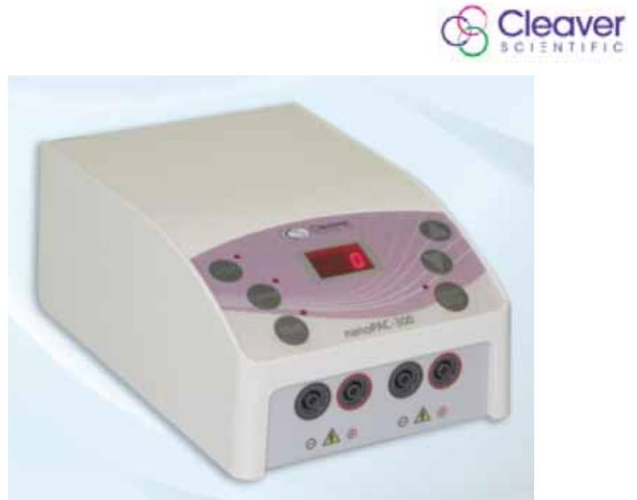
Le bloc d'alimentation peut être utilisé aussi bien pour les systèmes horizontaux Scientific multiSUB mais aussi les systèmes OmniPage gel mini, verticaux.
