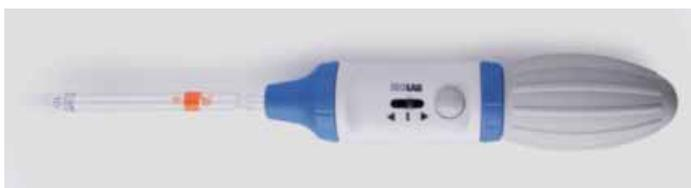
Possède une poire d'une grande capacité et convient pour toutes tailles de pipettes de 1 ml à 100 ml.
