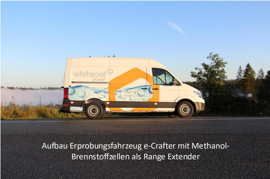
Aufbau Erprobungsfahrzeug e-Crafter mit Methanol-Brennstoffzellen als Range Extender
