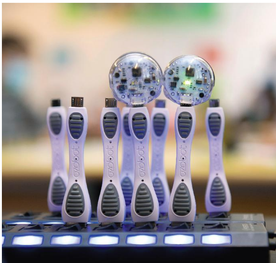
Die Miniroboter «Ozobots» lassen sich mittels Linien- und Farbecodes steuern, respektive codieren und können auch mit der Web-App «Ozoblocky» programmiert werden. Foto: Christoph Imseng.
