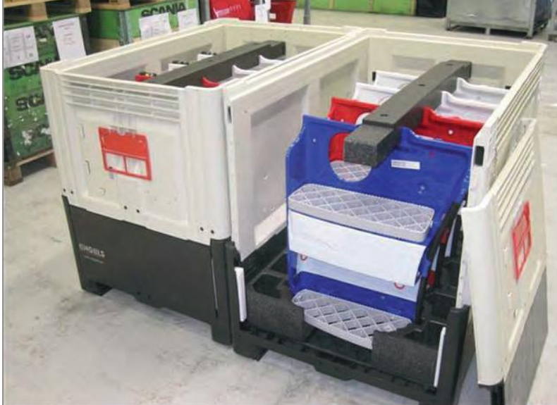
Opvouwbare 'hygiënische' palletbox met uitneembare wand.
