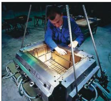
Spuitsietmal: vormgevende delen buitenzijde van een Euro-tec bak.
