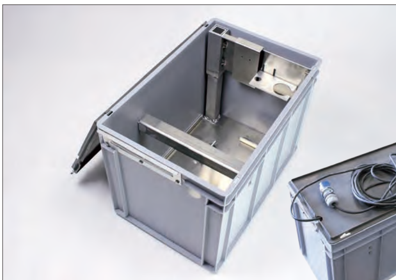
Maatwerk stalen inserts t.b.v. afvalwaterpompen in Rako bakken.
