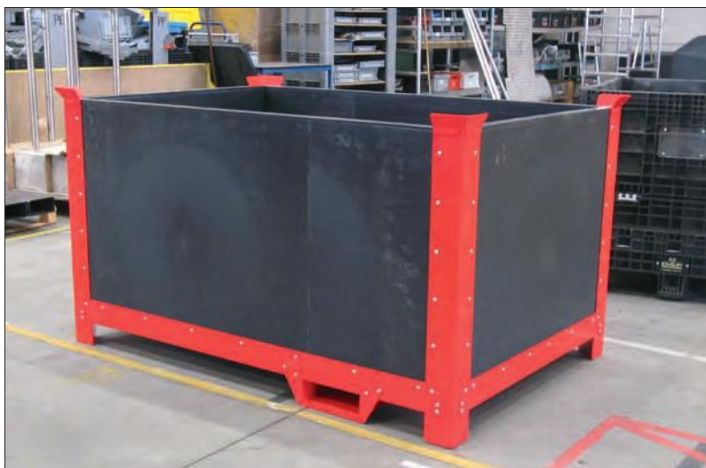
"Stille" opvangbak voor stalen reststukken gemaakt van een metalen frame met kunststof panelen. Ontworpen voor Volkswagen.
