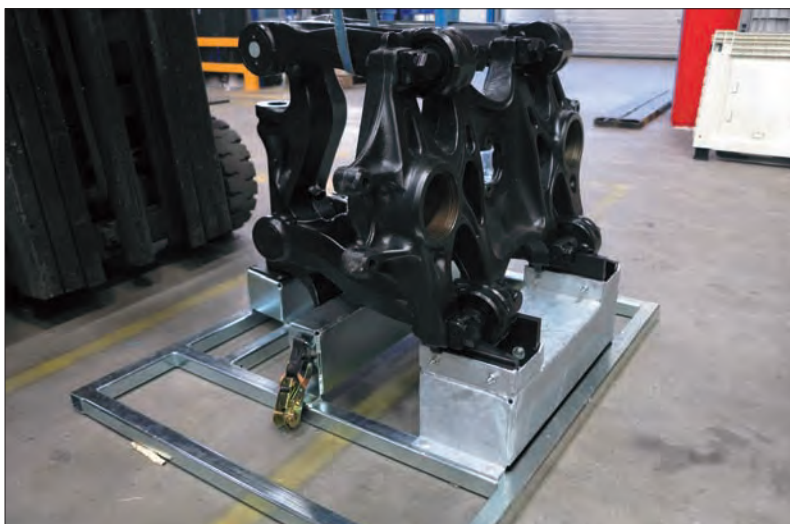
Een volledig uit staal vervaardigde productdrager voor een onderdeel van een landbouwvoertuig. De productdrager is passend gemaakt voor gebruik in combinatie met een Smartbox.
