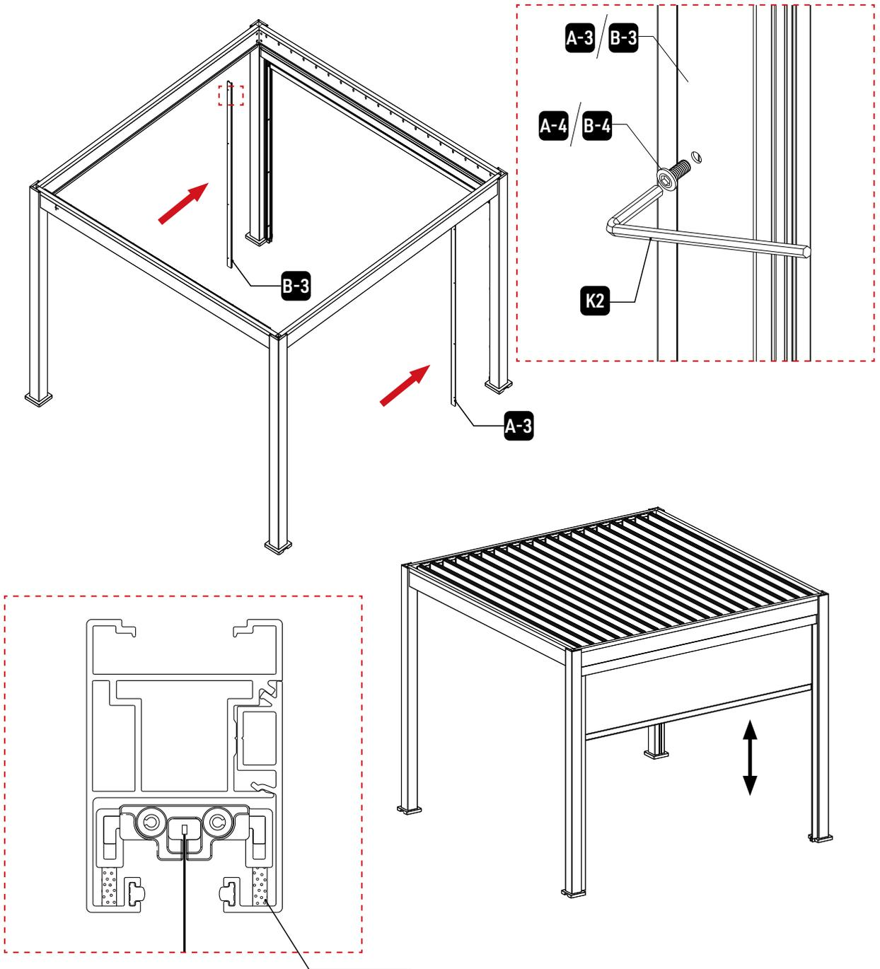
Bitte stellen Sie sicher, dass der Schaumstreifen an den Seiten von A-2/B-2 in die U-Nut des Rahmens des Sonnenrollos eingesetzt ist.
