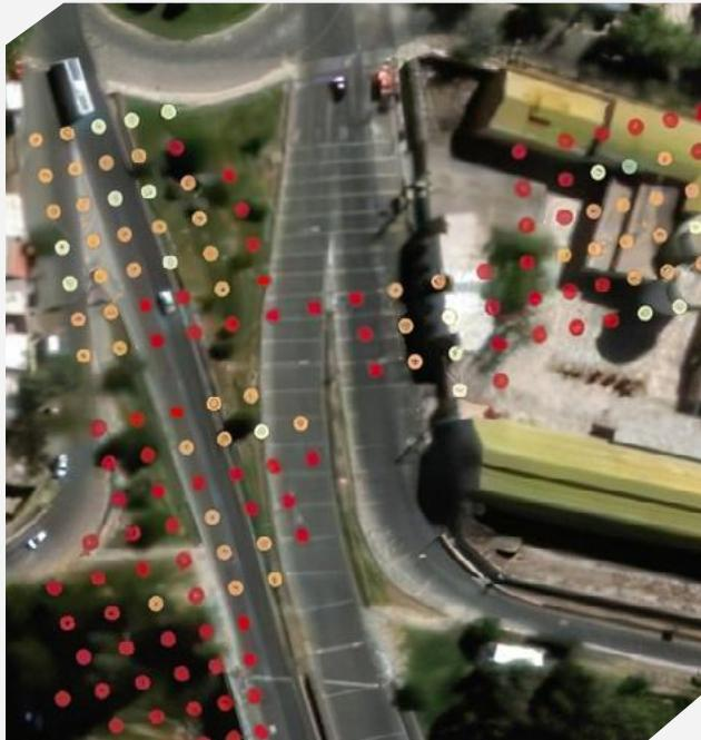
Debido a la alta frecuencia de revisita de la constelación SAOCOM, junto con la resolución de su radar, es posible detectar deformaciones sub-centimétricas en infraestructura crítica mediante técnicas de Interferometría SAR. Esto posibilita el seguimiento del estado estructural de rutas, puentes, oleoductos, represas y vías férreas, anticipando fallas, optimizando tareas de mantenimiento y respaldando la toma de decisiones con información objetiva y periódica.
