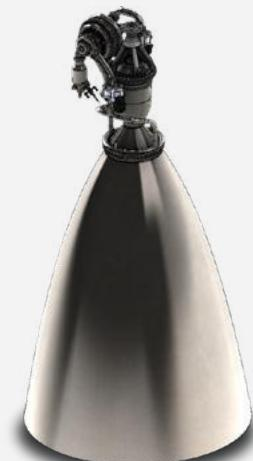
El RS-2 es un motor de cohete líquido bipropelente, de una sola cámara de empuje refrigerada regenerativa, alimentado en forma presurizada. Fue utilizado como plataforma de ensayos de inyectores swirl, caracterización de ignición y evaluación de cargas térmicas de cámaras de empuje refrigeradas. La cámara de empuje fue fabricada por combinación de tecnología aditiva y electroforming.
