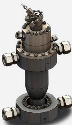
El RS-2 es un motor de cohete líquido bipropelente, de una sola cámara de empuje refrigerada regenerativa, alimentado en forma presurizada. Fue utilizado como plataforma de ensayos de inyectores swirl, caracterización de ignición y evaluación de cargas térmicas de cámaras de empuje refrigeradas. La cámara de empuje fue fabricada por combinación de tecnología aditiva y electroforming.
