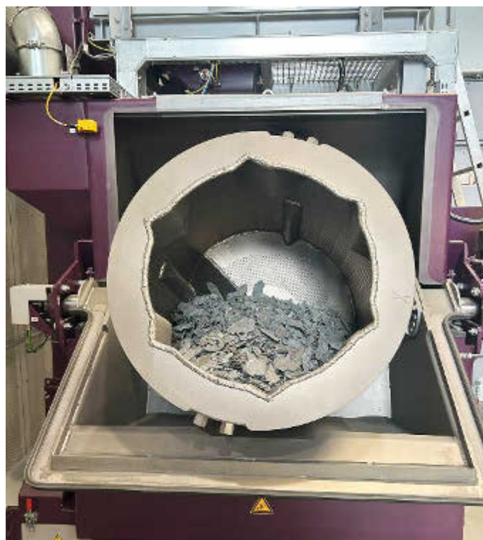
Recyceltes Material in einer AGTOS Trommel-Strahlanlage
