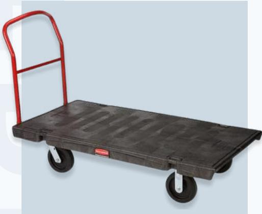
Plataforma robusta diseñada para cargas pesadas, con una capacidad de 2000 lb. Fabricada con espuma estructural sólida y texturizada, que minimiza el deslizamiento de la carga. Cuenta con un mango de acero con agarre variable y 4 ruedas de goma de 8 pulgadas de diámetro, configuración de la rueda rígido - giratorio.
