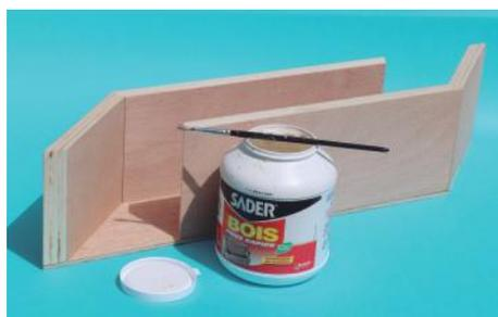
Construcción del tubo de madera, se pueden pegar las piezas con cola blanca de carpintero o bien fijarlas con tornillos.
