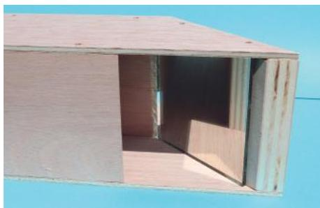
Los espejos, cortados a la medida oportuna los fijaremos con cinta adhesiva de doble cara en los extremos del tubo a 45 grados.
