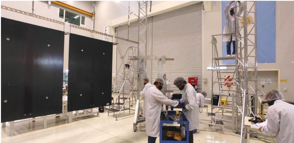
Ensayo de despliegue del panel solar en INVAP
