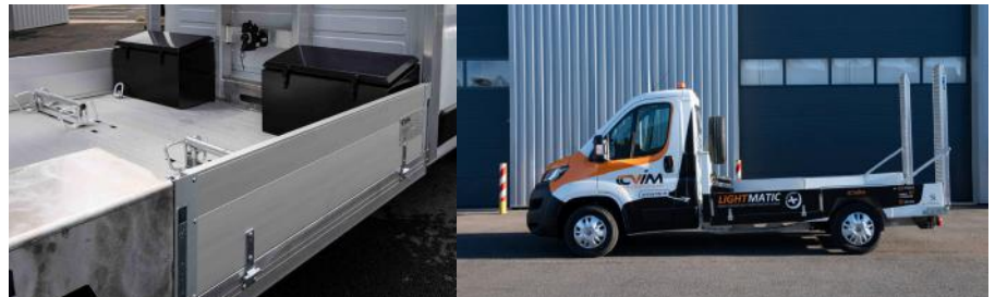
Remorque porte engins avec porte à faux articulé
