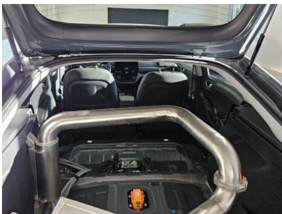
Ilustracja 3. Stanowiska dydaktyczne HYUNDAI IONIQ ELECTRIC oraz PHEV. To w pełni funkcjonalne pojazdy wyposażone w skrzynki pomiarowe. Umożliwiają pomiar parametrów, symulację usterek, odłączenie baterii HV oraz pomiary bezpośrednio na podzespołach.
