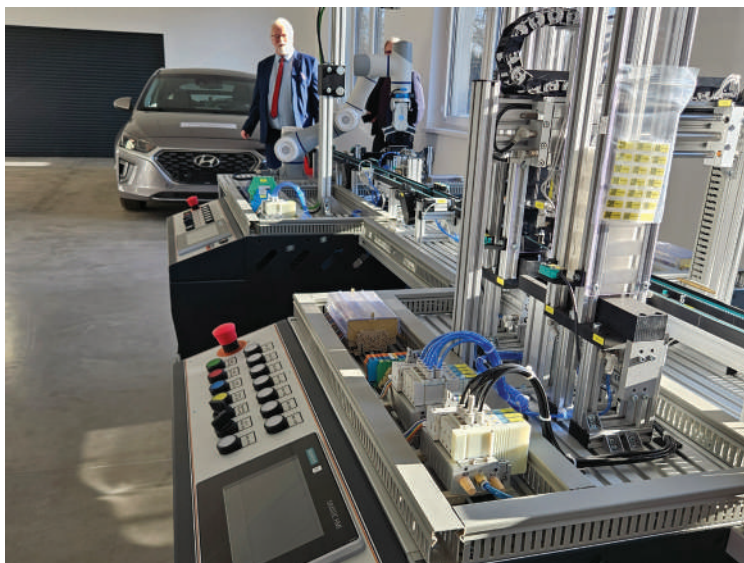
Ilustracja 1. Model linii produkcyjnej z robotem. Służy do nauki programowania i diagnozowania usterek. Nauczyciele mechatroniki będą z niej korzystać na końcowym etapie dedykowanego dla nich szkolenia.
