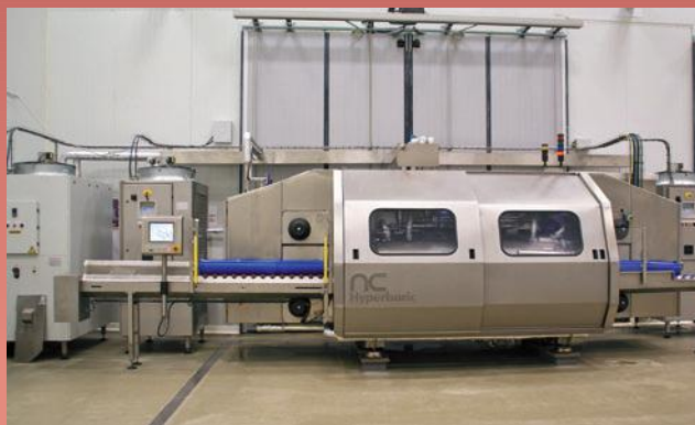
Presio handiak eta tenperatura handiak konbinatzeko aukera ematen du AZTI-Tecnalia duten ekipoa. ARG.: AZTI-TECNALIA.
