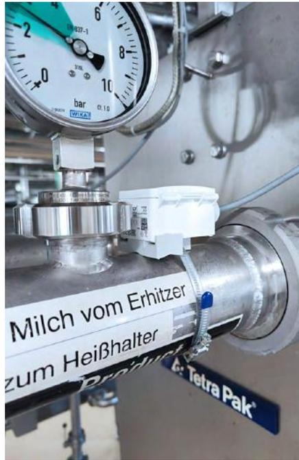
**Bild 3: Sensor Produktausgang**
