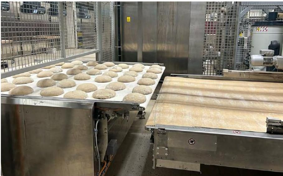
**Bild 5: Die Teiglinge werden vom Band an den MIWE athlet übergeben, der sie präzise in den Ofen einschießt. Der Beladevorgang lässt sich bis zu einem bestimmten Punkt manuell steuern, anschließend läuft der Prozess automatisch ab. (Quelle: MIWE)**
