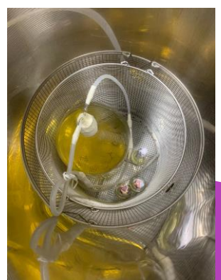
8. นึ่งฆ่าเชื้อ อณูหภูมิ 121 องศาเซลเซียส เวลา 5 นาที ภายใต้แรงดัน 15 ปอนด์/ตารางนิ้ว
