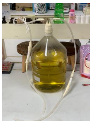
7. ต่อระบบเติมอากาศลงในถังหมัก มัดสายยางที่ท่ออากาศยาวให้แน่น
