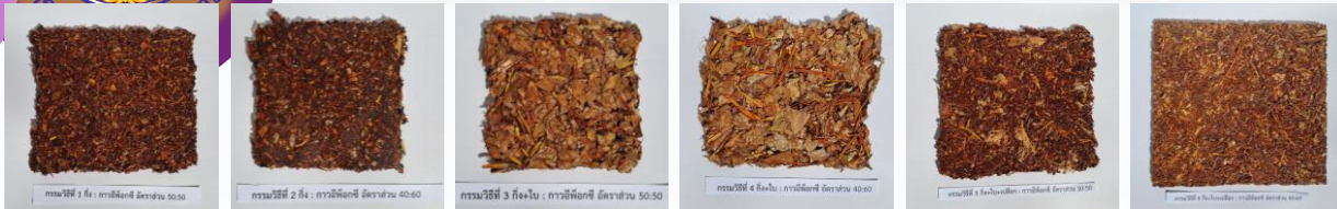
6. รอให้กาวแห้งประมาณ 18 ชั่วโมง แกะแผ่นชิ้นงานออกจากบล็อกเหล็ก
