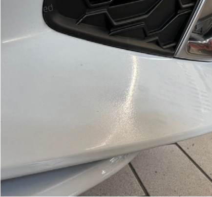
Riparazione della verniciatura scadente (spot repair)
