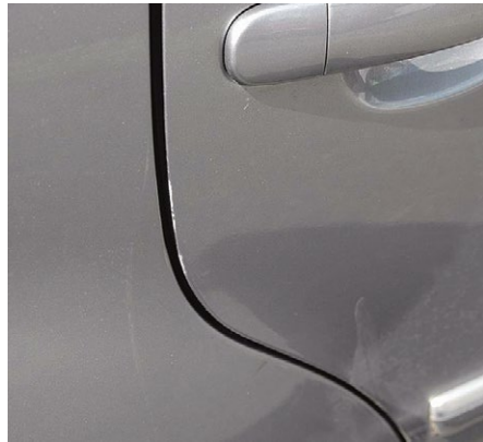
Lievi danni alla vernice
