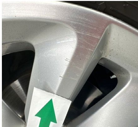
Graffi leggeri senza rimozione di materiale
