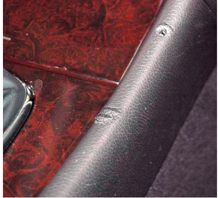
Deformazione del rivestimento in plastica
