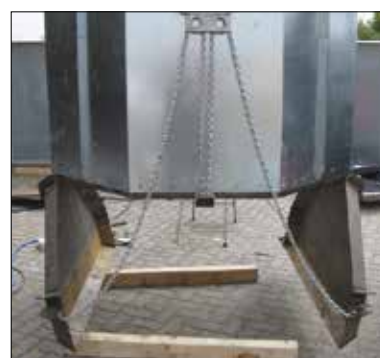
Dupla válvula de descarga, de abertura controlada. O interior do contentor equipado com dupla válvula não possui quaisquer partes móveis.
