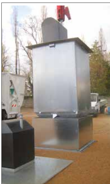
A proteção de segurança sobe quando o contentor é retirado da cuba.
