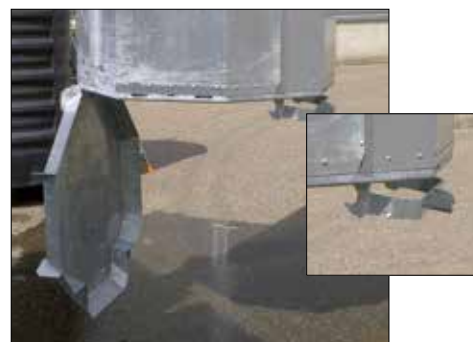
O esvaziamento dos contentores internos com válvula simples resume-se a elevar o sistema de argola simples com um gancho especial.
