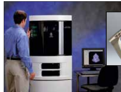
Häufig wird entschieden, ein Eins-zu-Eins-Modell anzufertigen, eine kostspielige Angelegenheit. Zum Glück kann inzwischen mithilfe schneller Prototyping-Maschinen, die über CAD-Programme gesteuert werden, innerhalb weniger Stunden ein Muster angefertigt werden.
