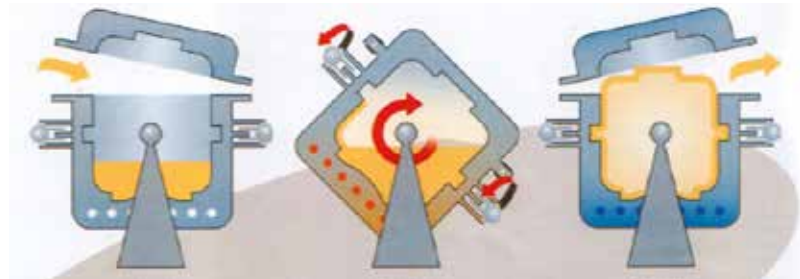
Schematische Darstellung des Rotationsverfahrens.
