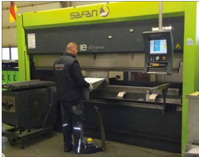
Unsere moderne Biegemaschine funktioniert mit CNC-Steuerung. Selbst komplizierte Biegearbeiten in der Batch- oder Massenproduktion werden mit hoher Präzision ausgeführt.
