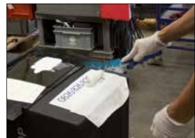
Die Schablone wird eingefärbt.
