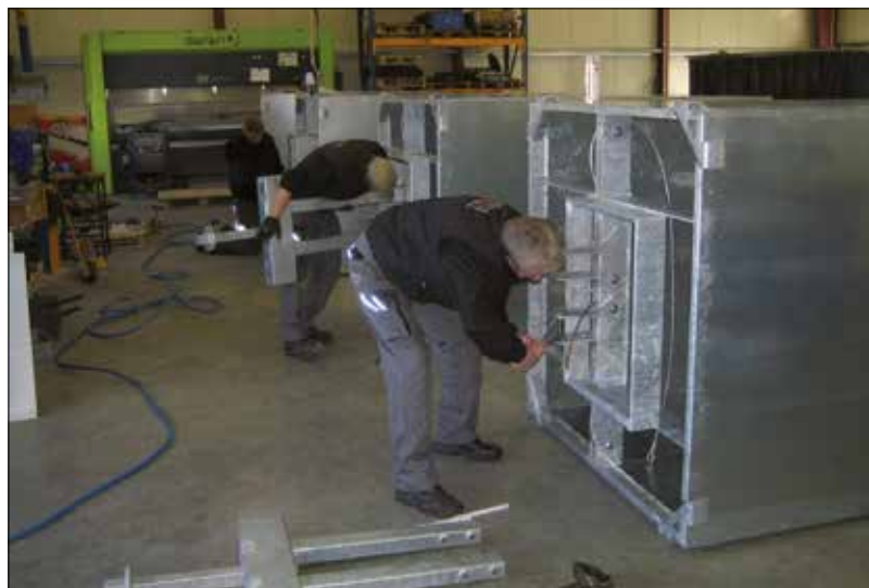
Montage von Unterflurabfallbehältern.
