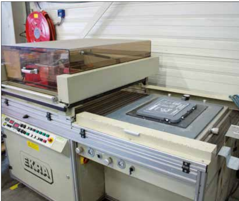
Maschineller Siebdruck auf Deckeln. Der Deckel wird maschinell unter dem Sieb positioniert und die Farbe wird automatisch gedruckt.
