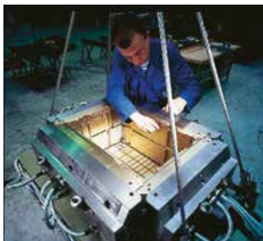
Spritzgussform: Formgebende Teile für die Außenseite eines Eurotec-Behälters.
