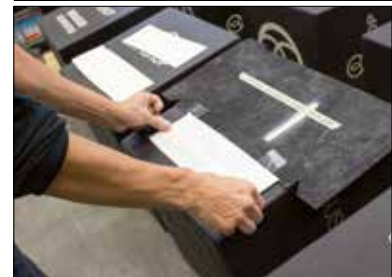
Die Schablone wird auf den Behälter geklebt.
