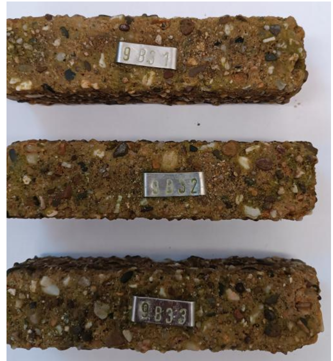
Bild 33: Mörtelprüfkörper B3 mit Portlandhüttenzement nach 21 Jahren Lagerung in Wasser mit kalklösender Kohlensäure ( w/z = 0,70 , z = 300 \text{ kg/m}^3 )
