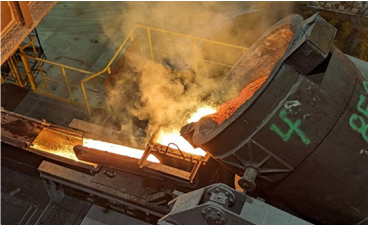
Bild 12: Wassergranulation der Elektroeroheisenschlacke (ERS) bei der zweiten Großversuchskampagne
