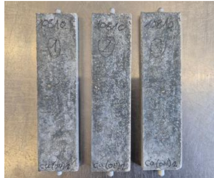
Bild 9: Intakte Mörtelprüfkörper mit Hüttensand HSD 243 bei einem HS/KL-Verhältnis von 75/25 nach 5.475 Tagen bei 8 °C in \text{Ca(OH)}_2 -Lösung
