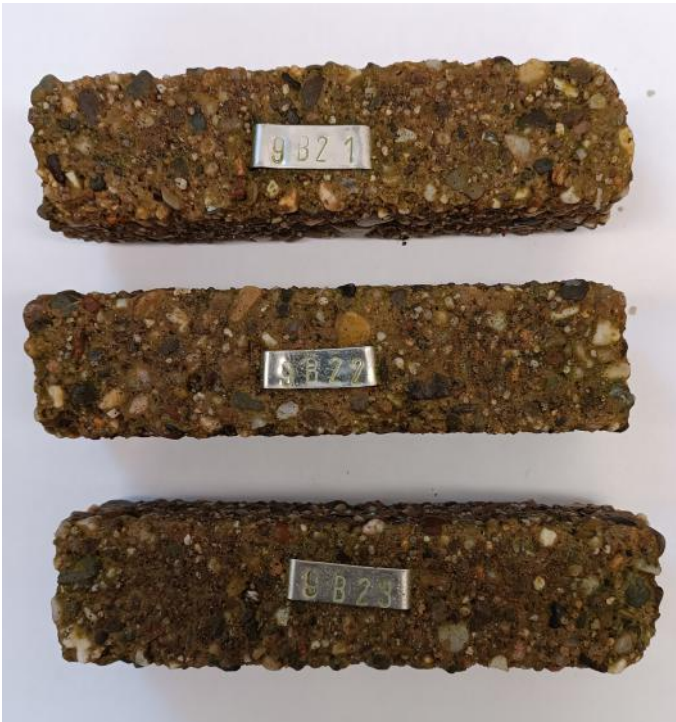
Bild 32: Mörtelprüfkörper B2 mit Portlandhüttenzement nach 21 Jahren Lagerung in Wasser mit kalklösender Kohlensäure ( w/z = 0,45 , z = 320 \text{ kg/m}^3 )
