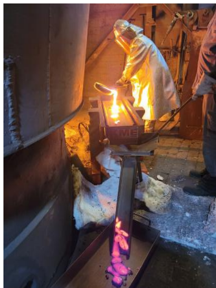
Bild 2: Abgießen einer Löffelprobe auf die Kupferrüttelrinne (links) und abgeführte und bereits abgekühlte Schlackenproben am Ende der Strahlrinne (rechts)
