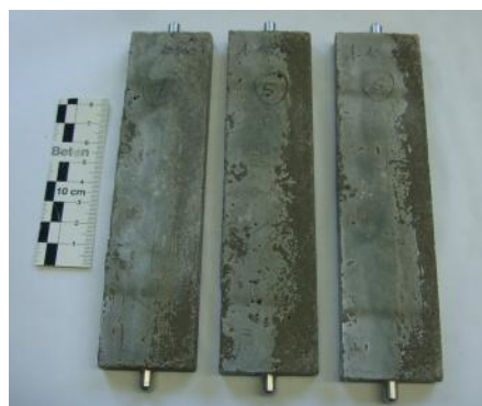
Bild 6: Intakte Mörtelprüfkörper mit Hüttensand HSD 234 bei einem HS/KL-Verhältnis von 50/50 nach 1.095 Tagen bei 20 °C
