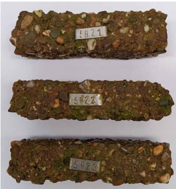
Bild 30: Mörtelprüfkörper B2 mit Portlandkalksteinzement nach 21 Jahren Lagerung in Wasser mit kalklösender Kohlensäure ( w/z = 0,45 , z = 320 \text{ kg/m}^3 )
