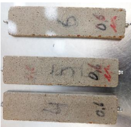
Bild 18: Mörtelprüfkörper mit Slagstar® (w/z = 0,6) nach 20 Jahren Lagerung bei 8 °C
