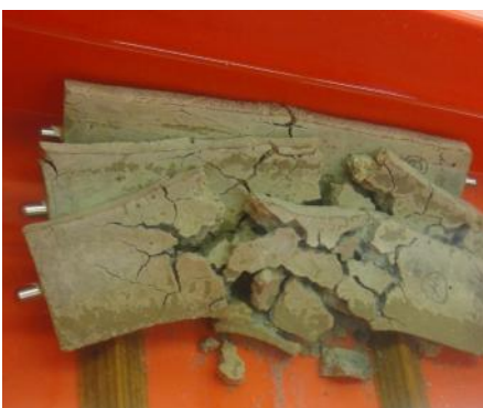
Bild 5: Zerstörte Mörtelprüfkörper mit Hüttensand HSD 234 bei einem HS/KL-Verhältnis von 40/60 nach 915 Tagen bei 20 °C
