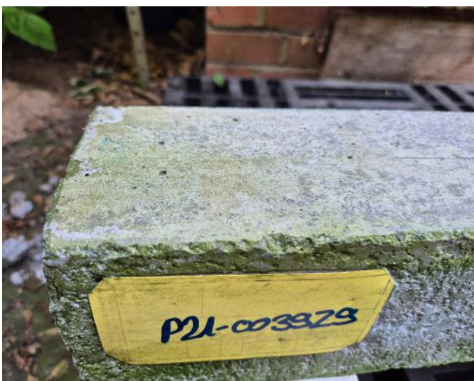
Bild 34: Intakter Betonprüfkörper mit Elektroofenschlacke EOS-2 als Gesteinskörnung nach 1.392 Tagen Auslagerung im Freien unter Dach
