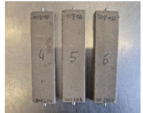
Bild 10: Intakte Mörtelprüfkörper mit Hüttensand HSD 243 bei einem HS/KL-Verhältnis von 75/25 nach 5.475 Tagen bei 8 °C in \text{Na}_2\text{SO}_4 -Lösung
