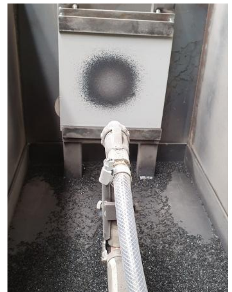
Bild 3: Positionierung der Strahlpistole und der Strahloberfläche in der Versuchsbox
