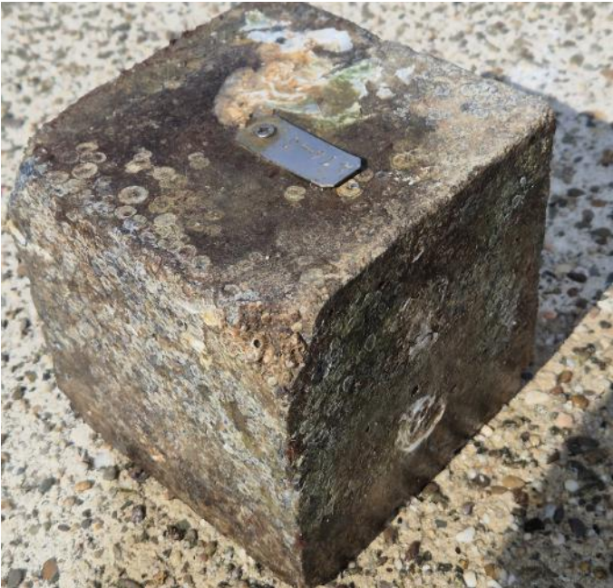
Bild 27: Eckenabplatzungen am Beton mit Portlandzement und MagnaDense® 20s
