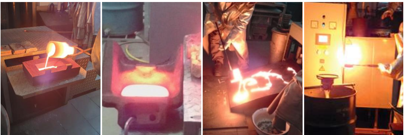
Bild 1: Erprobte Abkühlvorrichtungen (von links nach rechts): Sandbett, Eisenkokille, Stahlplatten (ungekühlt), Wassergranulation
