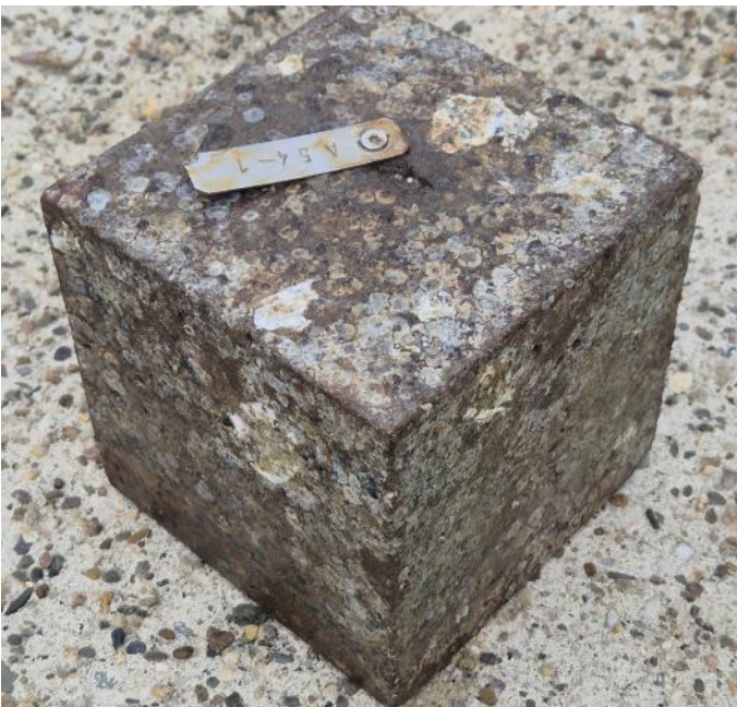
Bild 29: Intakter Probekörper des Betons mit Hochofenzement CEM III/B und EOS
