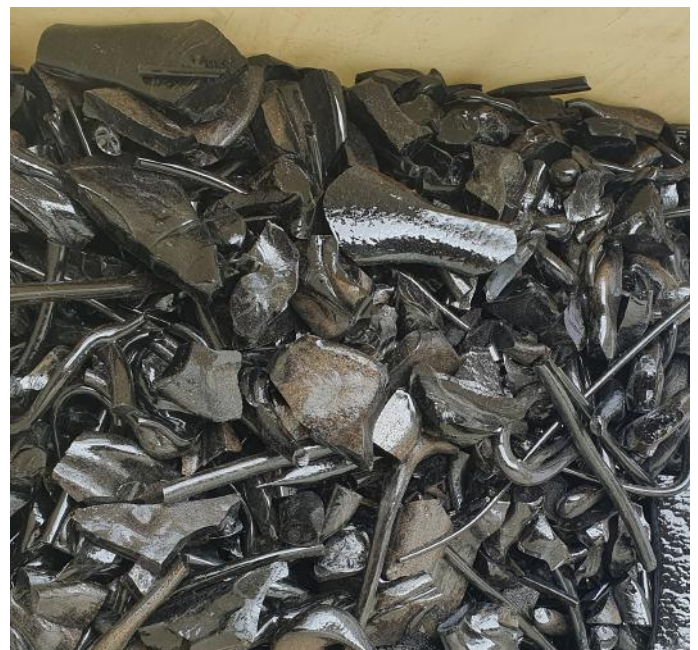
Bild 6: Foto der Hauptschlacke GJL aus der werkseigenen Abkühlung (links) sowie aus dem Betriebsversuch (rechts).
