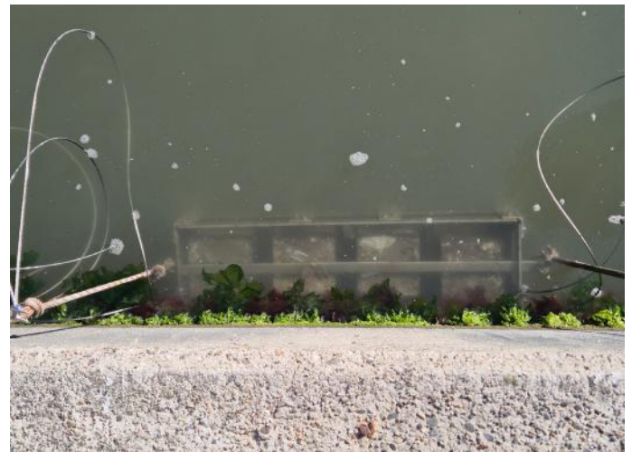
Bild 24: Lagerung der Probekörper in Edelstahlkäfigen im Wasser des Hafenbeckens
