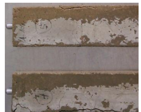
Bild 7: Gerissene Mörtelprüfkörper mit Hüttensand HSD 234 bei einem HS/KL-Verhältnis von 50/50 nach 3.650 Tagen bei 20 °C
