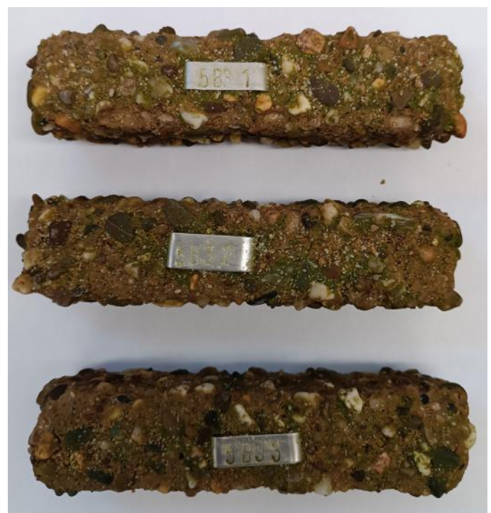
Bild 31: Mörtelprüfkörper B3 mit Portlandkalksteinzement nach 21 Jahren Lagerung in Wasser mit kalklösender Kohlensäure ( w/z = 0,70 , z = 300 \text{ kg/m}^3 )
