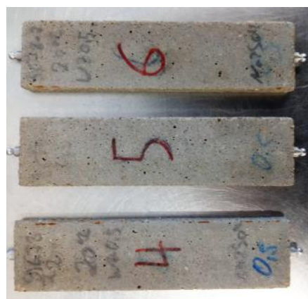
Bild 19: -Mörtelprüfkörper mit Slagstar® (w/z = 0,5) nach 20 Jahren Lagerung bei 20 °C
