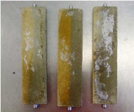
Bild 8: Intakte Mörtelprüfkörper mit Hüttensand HSD 234 bei einem HS/KL-Verhältnis von 75/25 nach 4.380 Tagen bei 20 °C
