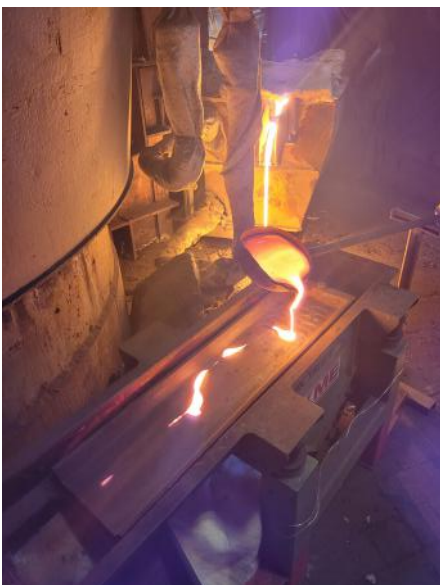
Bild 2: Abgießen einer Löffelprobe auf die Kupferrüttelrinne (links) und abgeführte und bereits abgekühlte Schlackenproben am Ende der Strahlrinne (rechts)
