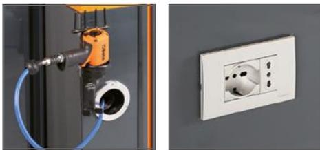
**CON MESA DE TRABAJO EN CHAPA PINTADA 2.050X700 MM FORRADA CON UNA CAPA DE PVC ANTICHOQUES Y ANTIRAYADURAS RESISTENTE A LOS HIDROCARBUROS TOMAS ELÉCTRICAS Y BOBINADO INTEGRADOS:**
