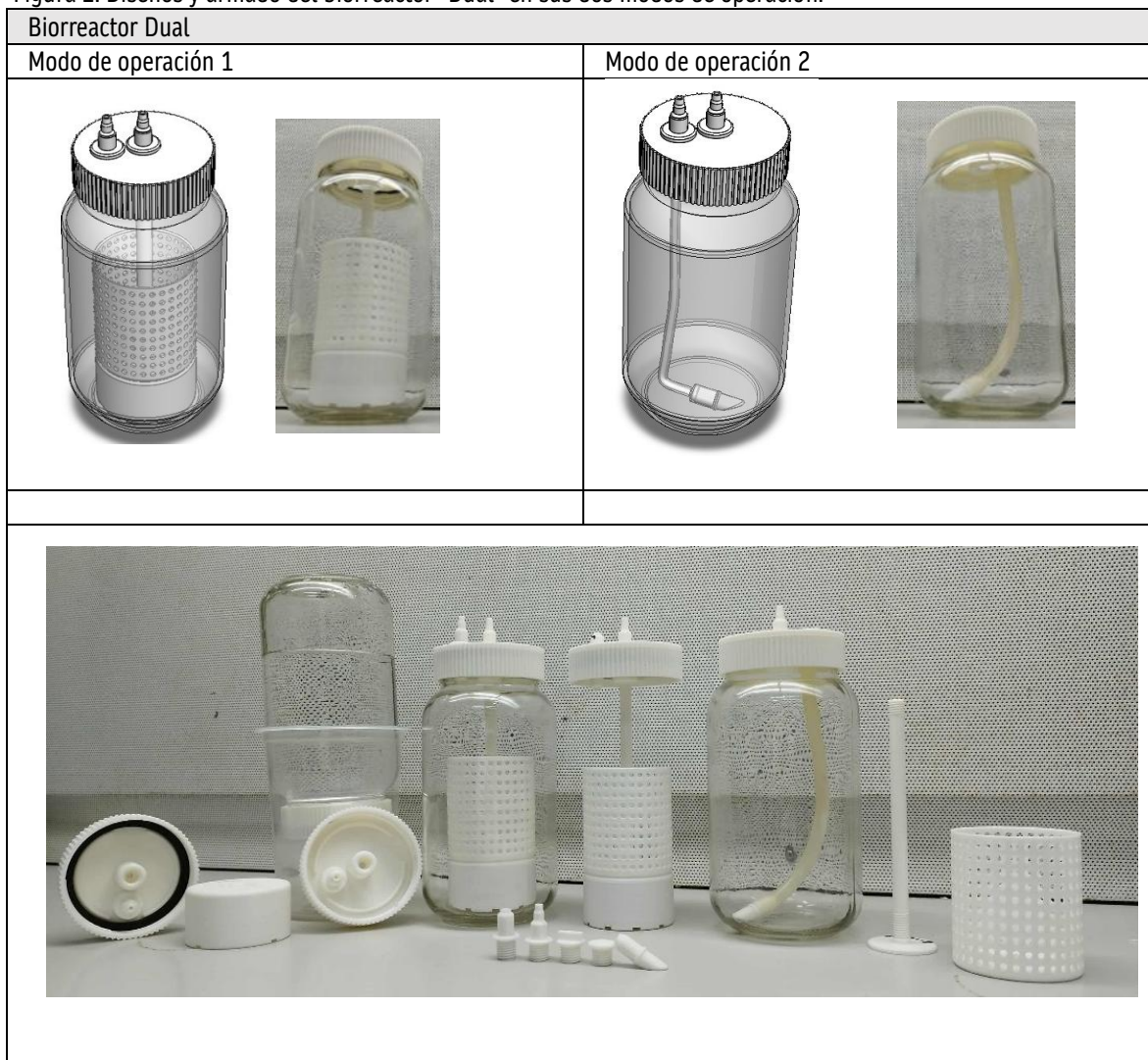
Figura 2. Diseños y armado del biorreactor "Dual" en sus dos modos de operación.
