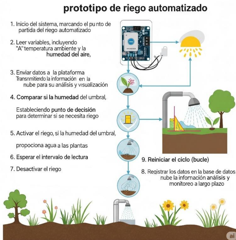
Figura 4. Esquema del funcionamiento del prototipo de riego. Autoría Propia.
