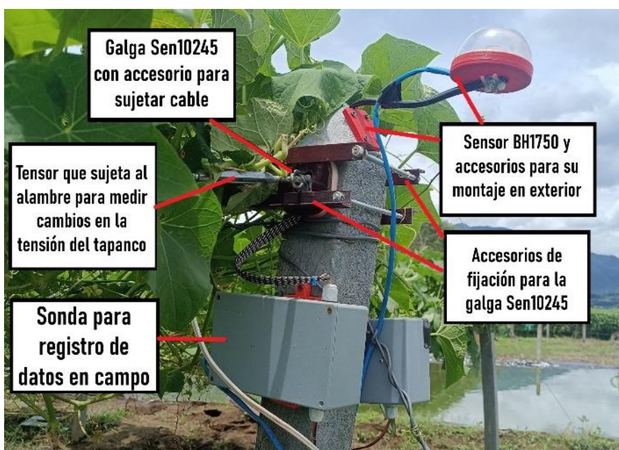
Figura 8. Módulo de registro instalado en campo y sus respectivos accesorios.
