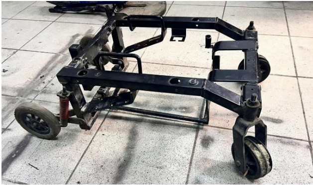
Figura 2. Estructura tubular base del FitoBot y estructura base con la colocación de la cuña y espacio para el contenedor.
