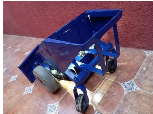
Figura 2. Estructura tubular base del FitoBot y estructura base con la colocación de la cuña y espacio para el contenedor.
