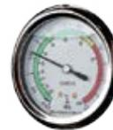
Manómetro para medir la alta presión del gas refrigerante
