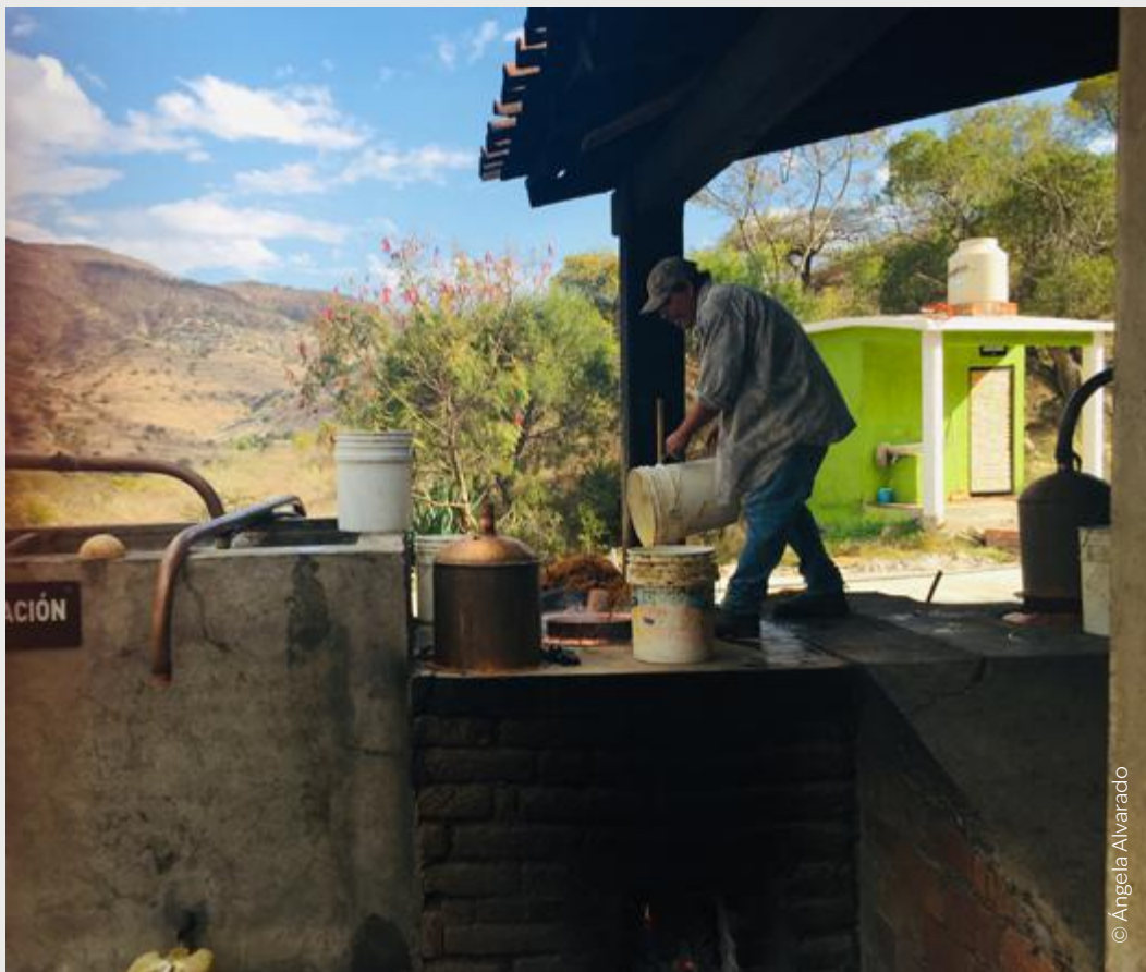
Figura 3. Destilación de mostos de agaves cocido en alambiques de cobre, Oaxaca.
