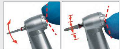
Ein einfach zu bewegender Kippschalter am Winkelstückkopf lässt zwischen axial freidrehenden oder axial fixierten Instrumente wählen.
