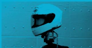
Die Aerodynamik zu verbessern ist wichtig, um Ermüdungszustände zu verhindern. Die Kraft, die auf den Nacken eines Motorradfahrers wirkt, wird nicht nur durch das Gewicht, sondern auch durch den Windwiderstand erzeugt.
