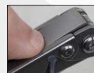
Botones de desbloqueo de herramientas
