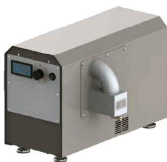
Obr. 1: Centrifugal Partition Chromatography systém miniLiLi od společnosti LiLiChro.
