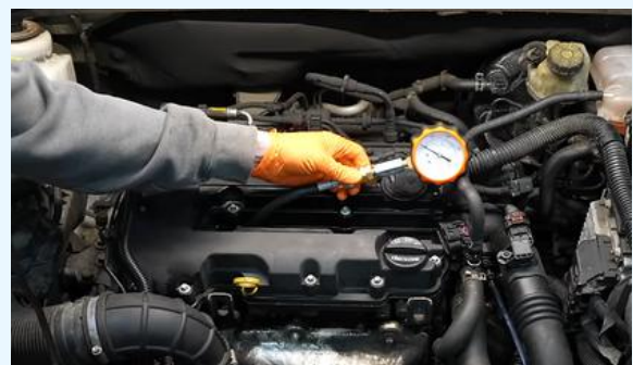
Ujian pemampatan silinder
