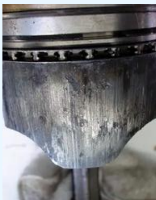
Kesan calar pada badan omboh ( piston ) kerana tiada pelinciran
