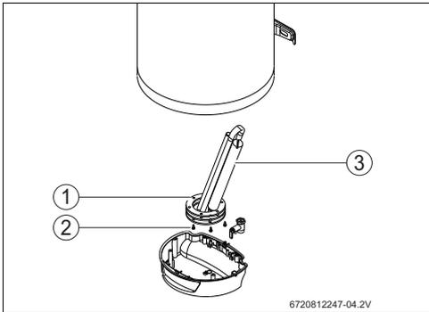
Fig. 12 Acesso e identificação dos componentes internos
