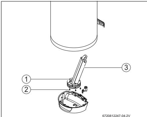
Fig. 12 Acceso a la zona interior e identificación de las partes
