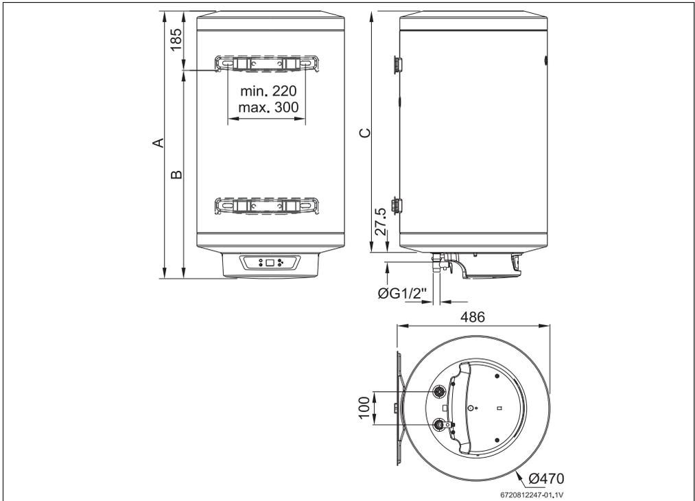
Fig. 2 Dimensiones en mm (Montaje mural, instalación en posición vertical)
