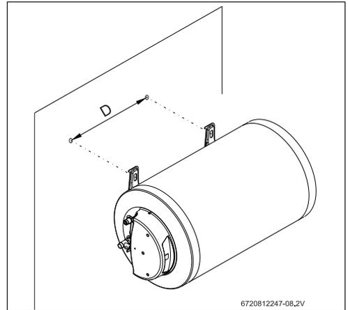
Fig. 9 Instalação na horizontal (montagem mural)
