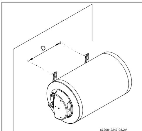
Fig. 9 Instalación en posición horizontal (Montaje mural)
