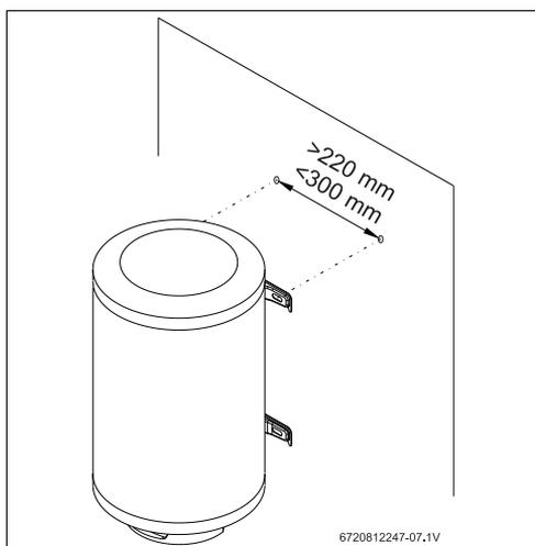
Fig. 8 Instalación en posición vertical (Montaje mural)
