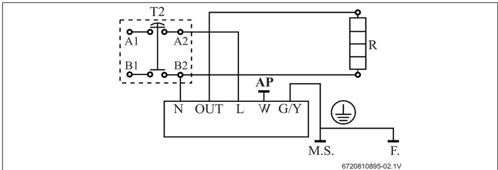
Fig. 14 Esquema de conexiones
