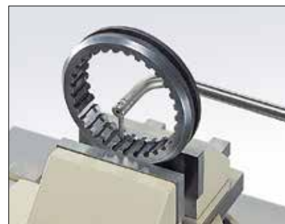
Diente de un engrane interno
