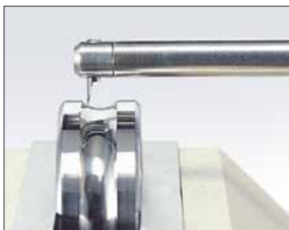
Contorno interior y exterior de un cojinete
