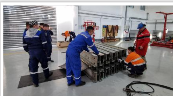
1400 мм хүртэл өргөнтэй конвейерийн туузыг халуун аргаар холбох, засварлах онол, практик хосолсон сургалтыг бид өөрийн халуун дарлагын машиныг ашиглан явуулдаг.
