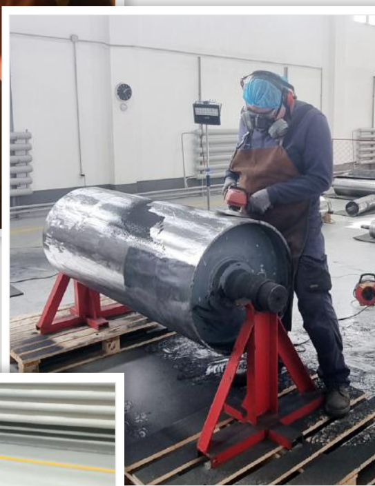
1600 мм өргөнтэй, 630мм голчтой хөтлөгч булыг 12 мм зузаантай REMAGRIP 60/CN резинээр хуяглахад бэлтгэн металл гадаргуун цэвэрлэгээг хийж буй байдал
