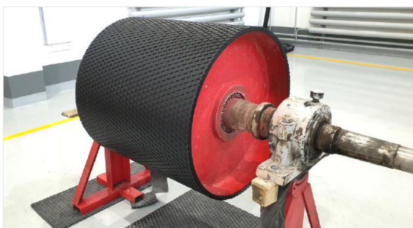
Цементийн үйлдвэрийн +100°C хэмийн ажлын орчинд ашиглагддаг 800 мм голчтой, 800 мм өргөнтэй хөтлөгч булыг хүйтэн аргаар хуягласан байдал
