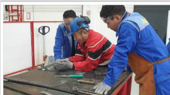
Конвейерийн EP үетэй туузыг хэрхэн зөв шатлан зүсэх аргачлалыг манай мастер багш С. Галбаатар Дулааны Дөрөвдүгээр Цахилгаан Станц ТӨХК-ийн ажилтнуудад зааж буй нь.
