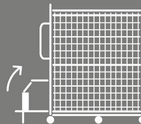
Fußbedienung möglich, da keine zusätzliche Verriegelung erfolgen muss
