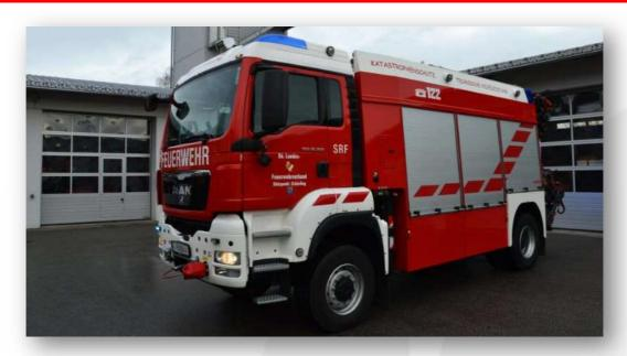
Fahrzeug mit Kran und Seilwinde sowie Gerätschaften für schwere technische Einsätze auf Straße und Schiene (VU, verschüttete Personen, Zugsunglück, LKW Unfälle, Sturmschäden, Stromversorgungen, Überschwemmungen,...)
