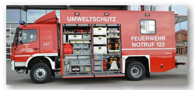
Fahrzeug mit Gerätschaften zum Auffangen, Abdichten und Umpumpen bei Unfällen mit Gefährlichen Stoffen auf der Straße, Schiene, Schiffsverkehr und in Betrieben. Außerdem ausgestattet mit zahlreichen Geräten und Unterlagen zum Aufspüren, Erkennen und Identifizieren von Gefährlichen Stoffen
