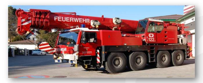
Stützpunktfahrzeug des Landesfeuerwehrverbandes für das gesamte Innviertel. Sofort verfügbares Kranfahrzeug bei schweren Verkehrsunfällen, Zugsunglücken, Gebäudeeinstürzen, Freimachen von Verkehrswegen, Fahrzeugbergungen, Sturmschäden, Höhenrettung, etc.
