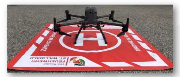
Folgende Einsatzzwecke sind für die Drohne vorgesehen: Feststellung der Einsatzlage, Darstellung der aktuellen Einsatzlage sowie Dokumentation derselben, Versorgung der Einsatzleitung mit Livebildern. Aufspüren von Wärmequellen bzw. Glutnestern bei Bränden, Suche nach Menschen und Tieren über optische oder wärmetechnische Eindrücke, usw.
