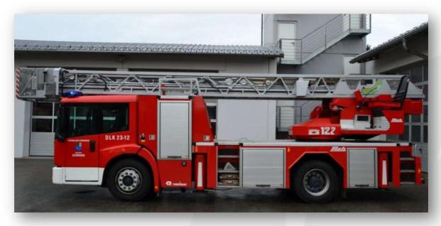
Maximale Rettungshöhe 30 Meter. Fahrzeug zur Personen oder Tierrettung aus größeren Höhen, Zur (klein) Brandbekämpfung von erhöhter Position, Technische Hilfeleistungen.
