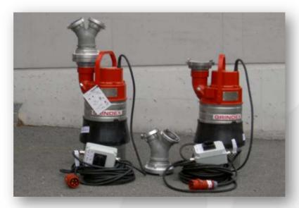
Schwere Schutzwasser-Tauchpumpen, geeignet für jegliche Art von Einsätzen. Ausgestattet mit einer Motorschutzeinrichtung, elektronischen Drehrichtungsschutz sowie Thermo-fühlern, und Trockenlaufsicher
