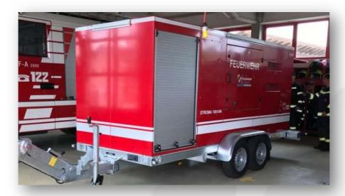
Autarke mobile Notstromversorgung mit Fixsatz "Strom" und "Beleuchtung" auf Anhänger mitgeführt. Einspeisevorrichtung (nur bei vorinstallierten externen Einspeisemöglichkeiten) mit Zubehör "Strom". Zusätzliche Verwendung als Pumpeneinheit zur Versorgung der zwei am Stützpunkt vorhandenen Schmutzwassertauchpumpen GRINDEX MASTER N (bis zu 4 Pumpen sind gleichzeitig zu betreiben)
