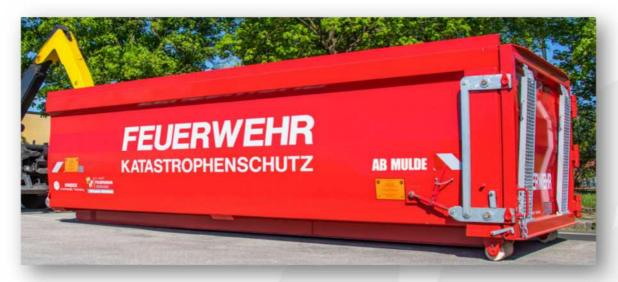
Multifunktionaler, offener Abrollcontainer (AB) im Format 20 Fuß (Länge ca. 6,40 m) zum Transport mit Wechselladefahrzeug (WLF) mit Multilift-Hakengerät geeignet. "Flugtauglich"
