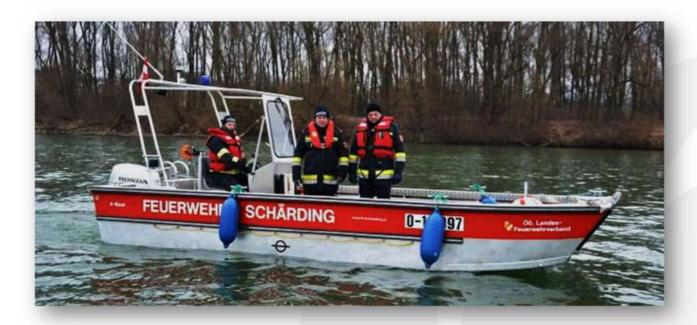
Wasserfahrzeuge zum Retten von Personen, Brandbekämpfung in Ufernähe und von Wasserfahrzeugen, Unterstützung von Taucharbeiten, Ausbringung von Ölsperren und Durchführung von Ankermanövern.
