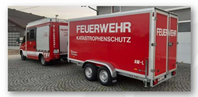
Zum Transport von bis zu 6 Rollcontainer "RC" mit einem Einzelgewicht von bis zu 450 kg, Transport von Ladegut auf bis zu 6 Europaletten mit einem Gesamtgewicht von max. 2 to, Transport von Einsatzmitteln des KHD
