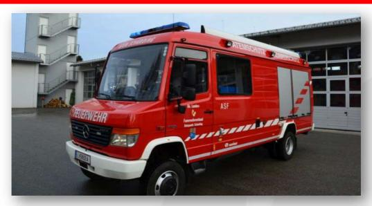
Fahrzeug zur Hilfeleistung im Einsatzbereich bei Großeinsätzen, wo eine sofortige Befüllung der Atemluftflaschen vor Ort notwendig ist, Begleitfahrzeug bei Taucheinsätzen, Hilfeleistung bei Schutzanzugeinsätzen sowie Assistenzleistung bei GSF-Einsätzen
