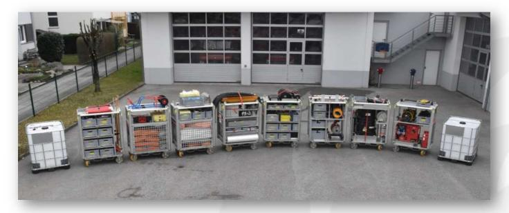
Rollcontainer mit div. Gerätschaften zum Auffangen, Abdichten und umpumpen bei Unfällen mit Mineralölen, Säuren, Laugen und gefährlichen Stoffen auf der Straße, Schiene, im Schiffsverkehr und in Betrieben.
