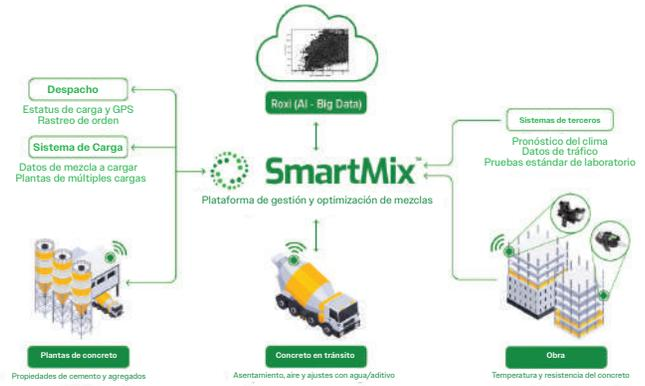
Fig. 10: Esquema de las interacciones de la plataforma SmartMix con los datos generados en la planta, en tránsito y en el sitio de trabajo.
