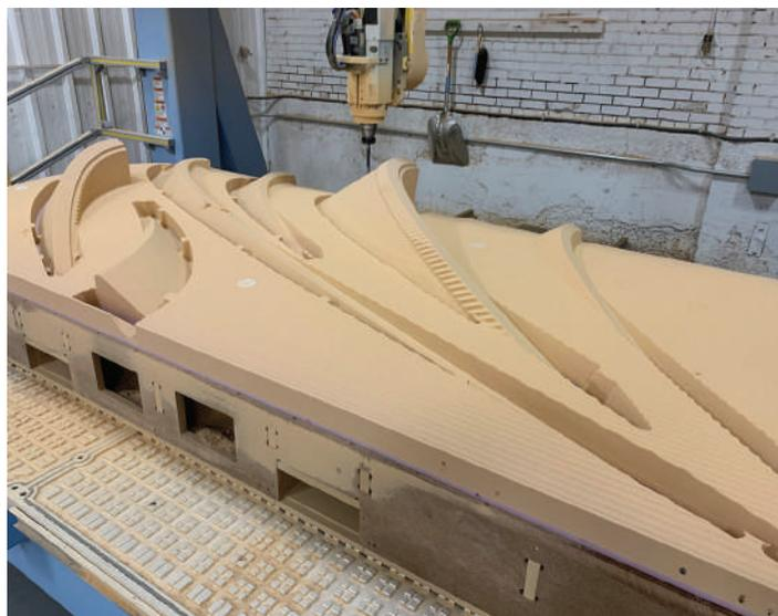
**Fig. 3: Características del diseño festoneado creado en MDF (fotografía cortesía de Unlimited Designs)**
