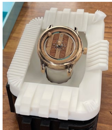
Les microballons de foot de 4 mm de diamètre indiquent les heures et les minutes sur cette montre réalisée par les étudiants IMM de SUPMICROTECH.
