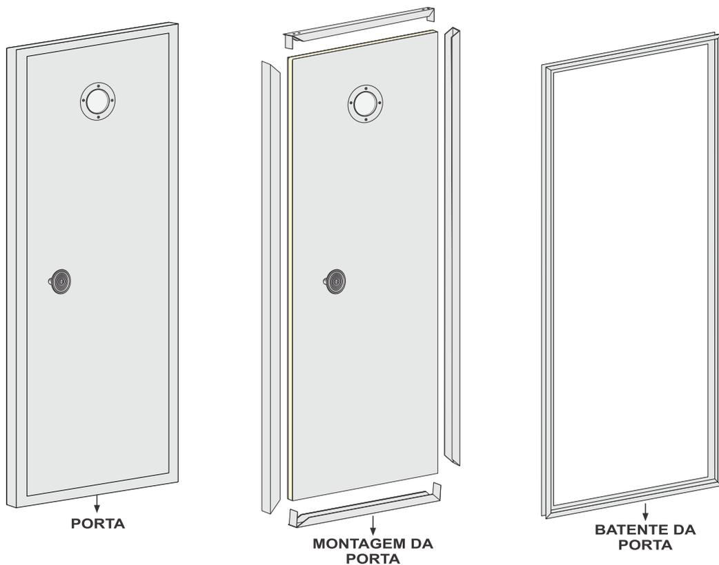
Não recomendamos que o batente seja chumbado com cal e/ou cimento, pois esse procedimento pode resultar em manchas sem remoção no aço inox e/ou alumínio. Para fixação utilize parafusos e buchas e faça a vedação com silicone. Lembrando que a porta deverá sempre abrir para fora e nunca para dentro do ambiente de sauna, isso é uma medida de segurança para uma boa utilização da sauna.
