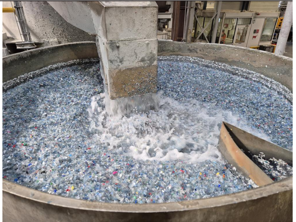
↑ Les déchets de plastique, transformés en paillettes, sont trempés une dernière fois dans un bain de flottaison, pour éliminer les colles, les étiquettes...
