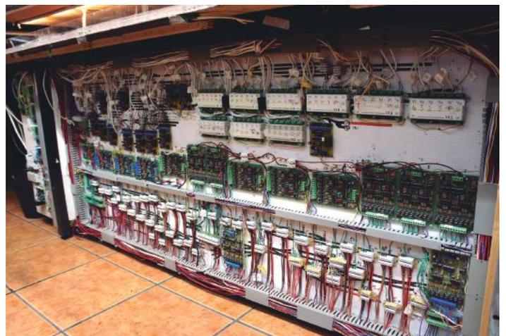
En los bajos de la maqueta se encuentra un panel en el que se han instalado los elementos de control digital (descodificadores y retromódulos).
