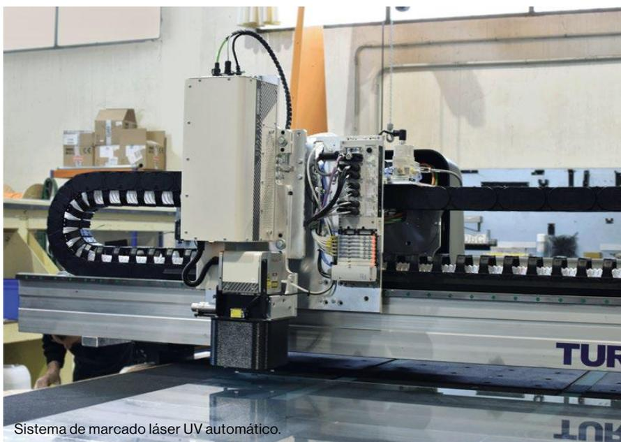
Sistema de marcado láser UV automático.
