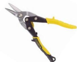
Acción de corte combinada. Filos serrados para evitar el deslizamiento en el corte. Tuercas cromadas. Capacidad de corte de hasta 1,2 mm. Válido para el corte de aluminio, láminas de PVC, mallas de acero, plástico, etc.
