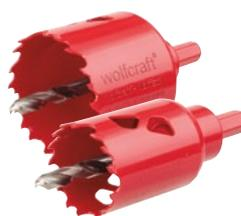
Para madera, metal, plástico, placas para construcción en seco y de aislante. Dentado variado progresivo de acero de alta velocidad (HSS) para agujeros de expulsión grandes. Vástago hexagonal de 9,5 mm de diámetro. Broca centradora de 6 mm de diámetro.
