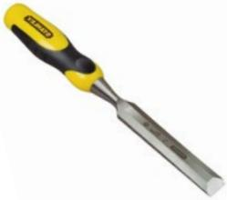
Formón con hoja de aleación de acero, rectificada y templeada en todas sus caras. Engrasada para impedir la corrosión. Mango bimatéria más grueso y amortiguador absorbente de los golpes.
