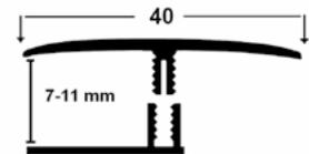
Compuesto de dos partes: un carril que se atornilla o pega en el suelo y una tapa que se encaja en este. La parte superior tiene un espesor de 1,6mm.
