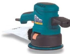
Combina movimiento rotativo y orbital, Dotadas de un nuevo sistema de protección contra el polvo y aspiración integrada que permiten el uso de abrasivos y platos estándar. Regulación electrónica de la velocidad y sistema de frenado del plato. 350W.
