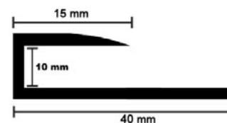
Perfil de aluminio para embutir el pavimento, quedando a la vista una pequeña parte del perfil de manera discreta.
