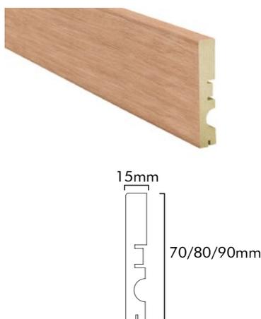
Largo 2400mm. Fabricado en MDF hidófugo. Incluye pasacables y sistema de enganche a presión para facilitar la colocación.
