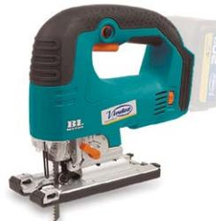
Dotada de motor brushless con base anti-ralladuras. Sistema de movimiento pendular ajustable en 4 posiciones. Base de inclinable de 0° a 45° para realizar cortes a inglete. Incluye cargador, batería y bolsa.
