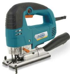
Con control electrónico de velocidad y un sistema de movimiento pendular ajustable en 4 posiciones. Base inclinable de 0° a 45°. Permite la realización de cortes circulares al poder usarse como compás. Con toma para aspiración externa.
