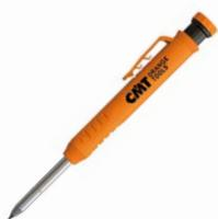
Para marcar superficies, ásperas o lisas, secas, húmedas o polvorientas, lugares estrechos y de difícil acceso. Cuerpo de metal resistente y práctico clip de bolsillo. Longitud de la punta 45 mm (Ø5,7 mm). Pulsador de alimentación para avance automático de minas con afilador integrado.
