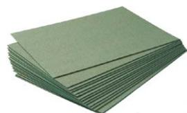
Producto a base de fibra de madera estable y sostenible. Aislamiento acústico (contra ruidos de impacto) bajo parquets macizos o flotantes hasta 19 dB/21db (Pro). Compensa las diferencias de nivel de un máximo de 3 mm.
