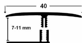
Compuesto de dos partes: un carril que se atornilla o pega en el suelo y una tapa que se encaja en este. La parte superior tiene un espesor de 1,6mm.
