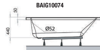
Hauteur sous plage sans tablier : 54-55,5 cm
